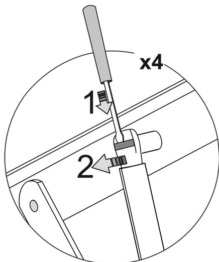
для снятия газового амортизатора:
